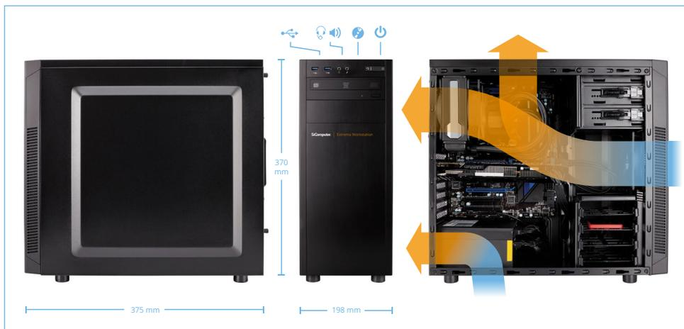
**Extrema Workstation W300 è realizzata per chi lavora con la progettazione ad alto livello, con il calcolo intensivo e con le applicazioni grafiche più complesse 2D e 3D (CAD, MCAD e DCC).**
